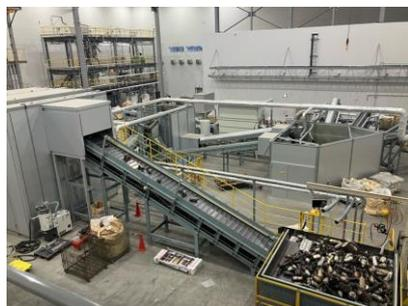
自動車触媒専用の処理装置
